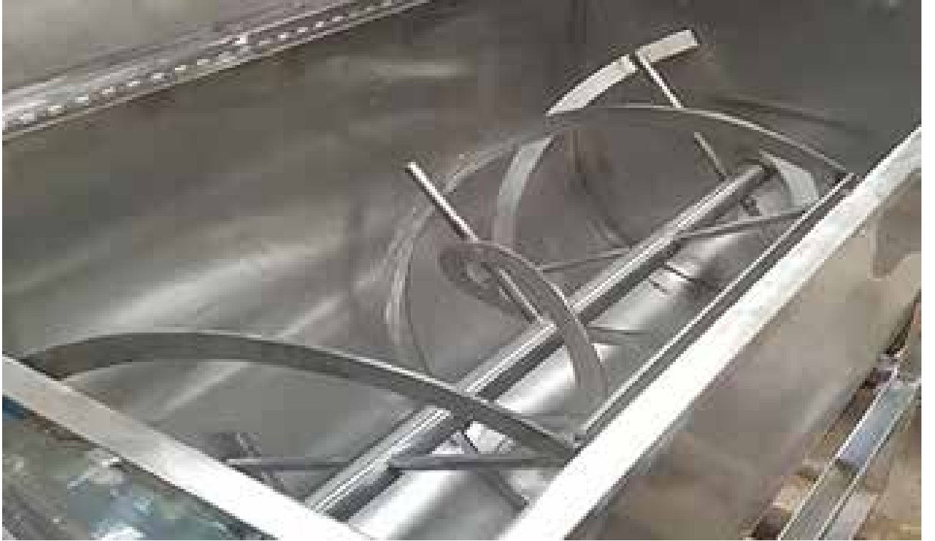
Şekil 1: Yatay mikserde ribon karıştırıcı
